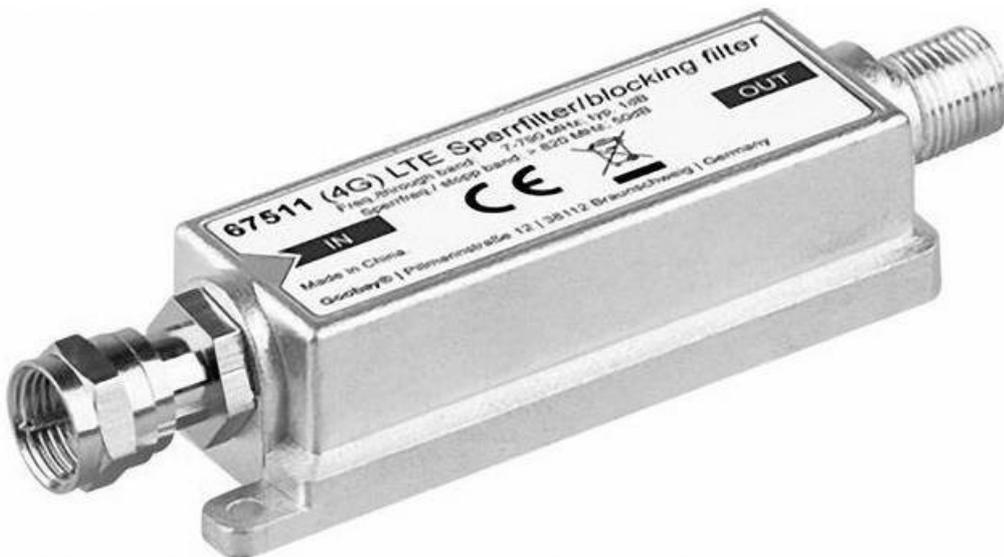
Echte Abhilfe schafft hier eine verbesserte Filterung der Frequenzen oberhalb der von uns genutzten 745 MHz. In einer kommenden neuen Version des Konverters werden die Filter direkt eingebaut, für die bisher verwendeten Konverter bietet sich ein Lösungsvorschlag von Jürgen DF1EO an. Er hat mit Erfolg einen F-Tiefpass für DVB-T verwendet (Goobay 67511, erhältlich u.A. bei Reichelt und Pollin) welcher den sauberen Empfang der WB Video-Bake aus Doha ermöglicht.
